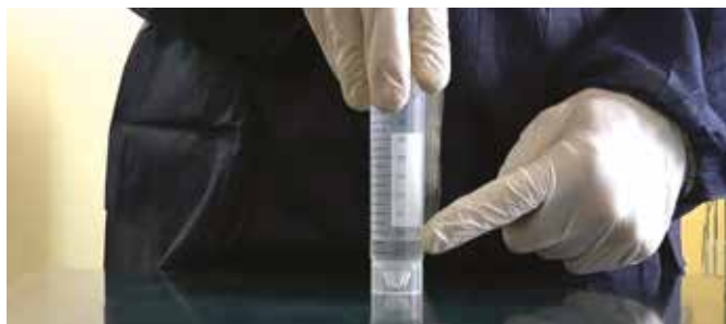
Контроль точности дозировки с использованием мерного цилиндра для каждой форсунки распылителя.
