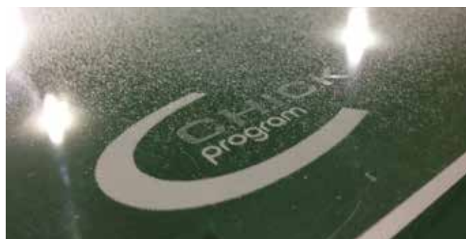
Поверхность устройства Desvac DROPLATE, предназначенного для контроля покрытия и равномерности распыления вакцины на ящики
